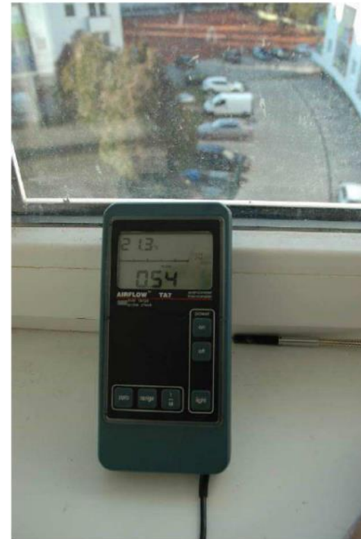
Obr.č.38 BYT č.44 - Prietok vzduchu na parapetnej doske okna
